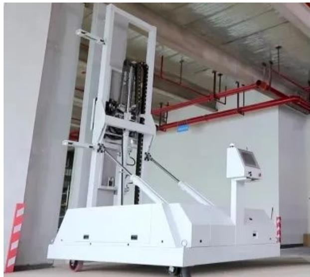
机器人安装 ALC 墙板 中建科工
