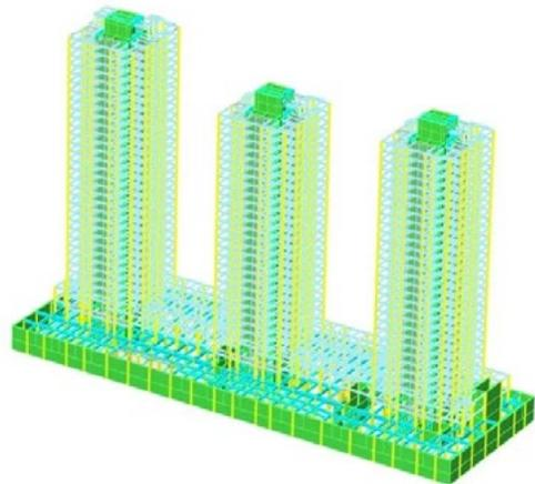
钢框架—混凝土核心筒结构体系 深大院
