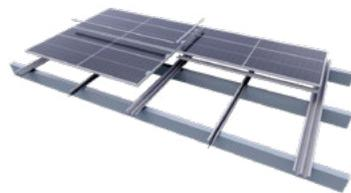
BIPV 系统分层构造
