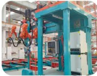
机器人自动填充焊机
